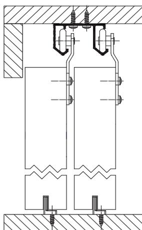
Фреза в нижнем торце двери для проводника
